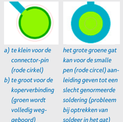
figuur 2c - te dikke pin in een nauw gat en verbindingsproblemen door boren
