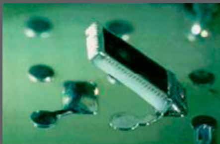
3. door thermische onbalans (verschil in afmetingen van pads) bestaat er risico tot tombstoning
