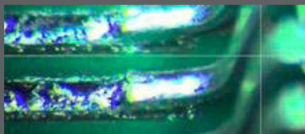
1. voorbeeld van een zwakke (l) en goede (r) soldeerverbinding
