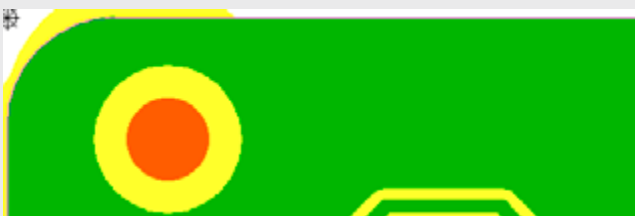
figuur 4 - fiducials (markeringen, rood) die zich te dicht bij de pcb-rand bevinden, blijven bij het vasthouden van de pcb in de plaatsingsmachine verborgen. Ze zijn onbruikbaar als referentiepunt waardoor de plaatsingsnauwkeurigheid van de machine afneemt
