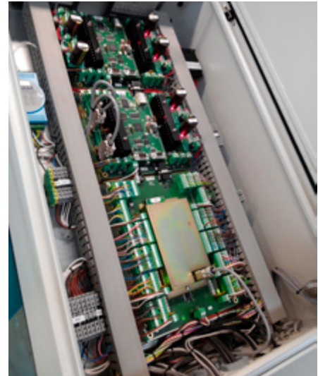
kast met elektronica die de machine bestuurt
