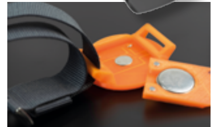
embedded watch een 3D-geprint horloge dat een microcontroller bevat, led's en een vervangbare batterijcel
