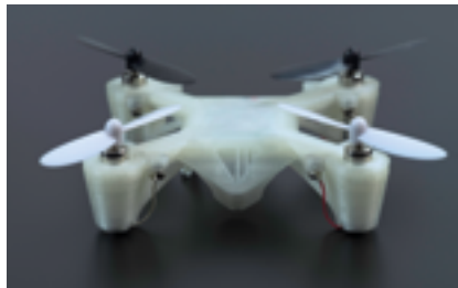
Quadcopter de 3D-geprinte Quadcopter communiceert met een bestaande embedded pcb; magnetische verbindingen zorgen voor contact tussen de pcb en de geprinte zilveren interconnecties
